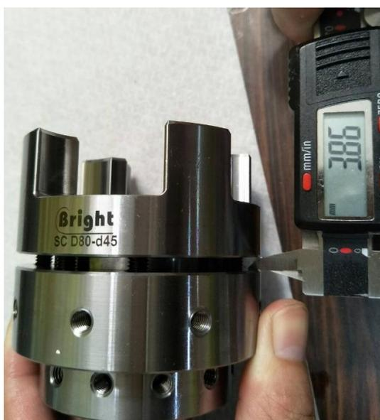
照片 2 為輕輕鎖上心軸時的縫隙值約 3.86mm，愈鎖固縫隙會愈小
