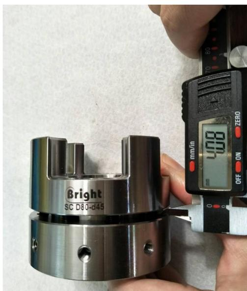
照片 1 完全鬆開螺絲(扭力值=0)的縫隙值(約 4.08mm)
