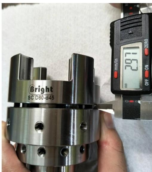
照片 3 依序鎖上扭力約 14Nm 時的縫隙值約 2.97mm。
