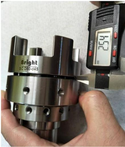
照片 5，若是繼續將螺絲鎖更緊，則縫隙值亦會繼續變小，如圖又比之前小了 0.53mm，變成 2.54mm。因此建議客戶縫隙值，並不是鎖緊的依據，使用扭力扳手測試鎖緊力量，才是正確的方式。
