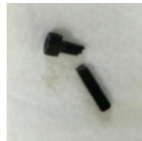
照片 8 過大扭力斷裂的螺絲
