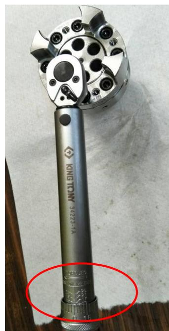
照片 4 依序鎖上扭力約 14Nm 時的縫隙值約 2.97mm。
